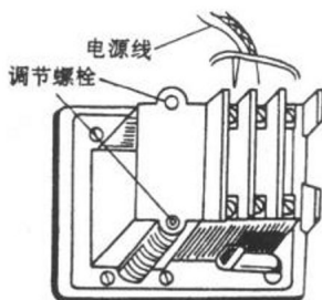
图 2-3 气压自动开关
