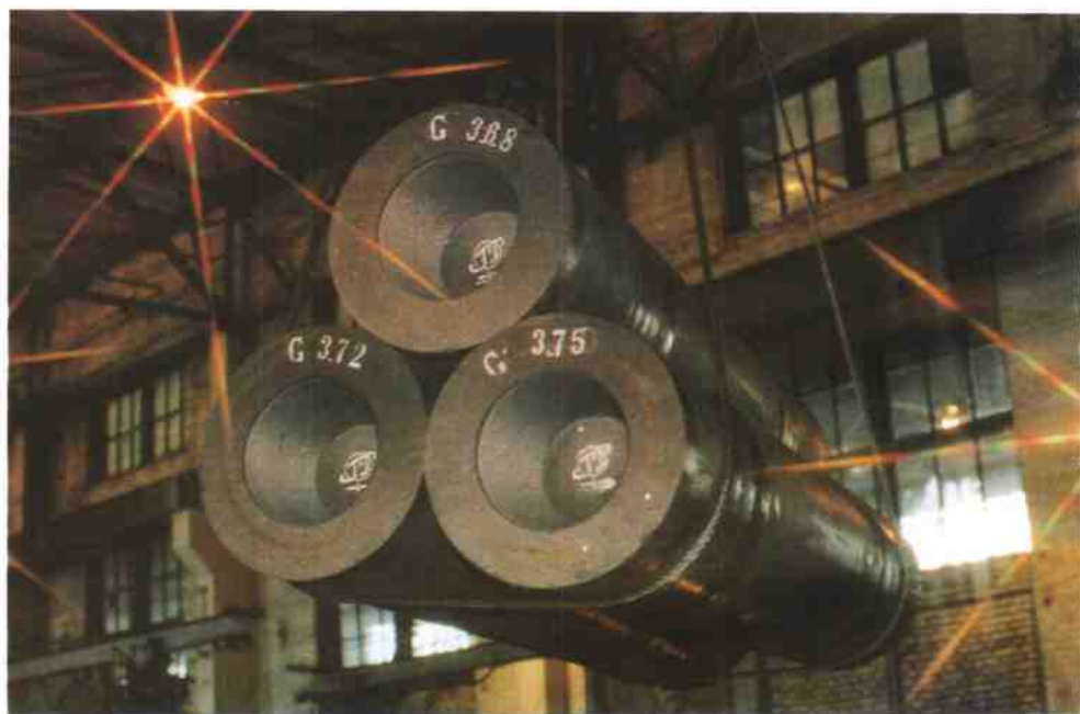
吉林炭素厂生产的超 高功率电极
