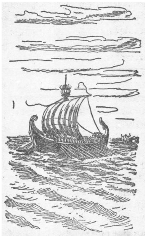
第二圖 三櫓大戰艦。在船前面露出水面的就是衝角。
