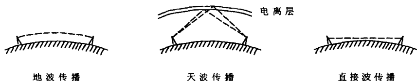
图 0-1 无线电波的传播途径
