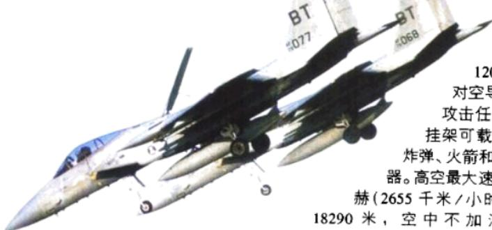
空对空导弹或8枚AIM-120A先进中程空对空导弹，执行对地攻击任务时5个武器挂架可载10705千克的炸弹、火箭和其他空对地武器。高空最大速度超过2.5马赫(2655千米/小时)，实用升限18290米，空中不加油最大航程5745.00千米，最大作战半径1152.00千米。其特点：一是机动性能好，特别适用于近距格斗和超视距攻击；二是空战火力强，武器命中精度高；三是机载电子设备性能好，具有较强的信息处理能力和电子对抗能力。主要用于夺取战区制空权，同时兼有对地攻击能力。在海湾战争中，F-15C战斗机总共部署了118架，出动5906架次，用于拦截和摧毁伊拉克飞机。在“沙漠风暴”行动击落的38架伊军飞机中，F-15C击落了33架而无一损失。
