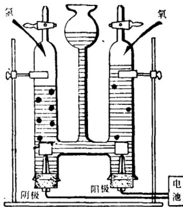
在水中加入稀硫酸（或氢氧化钠），以便于导电。然后放入白金电极、通上直流电，在阴极产生氢，在阳极产生氧，其体积比为 $2:1$ 。
