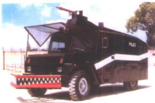
以色列“龙”式水炮车，水炮喷射染料水和催泪剂混合液可全自动脉冲，也可持续喷射，射程 50 米
