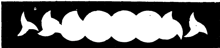
图8 镜头中间快门的启闭现象
