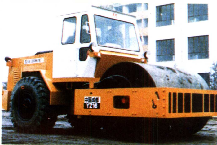
四川省公路机械修配厂生产的 YZ16 型振动压路机
