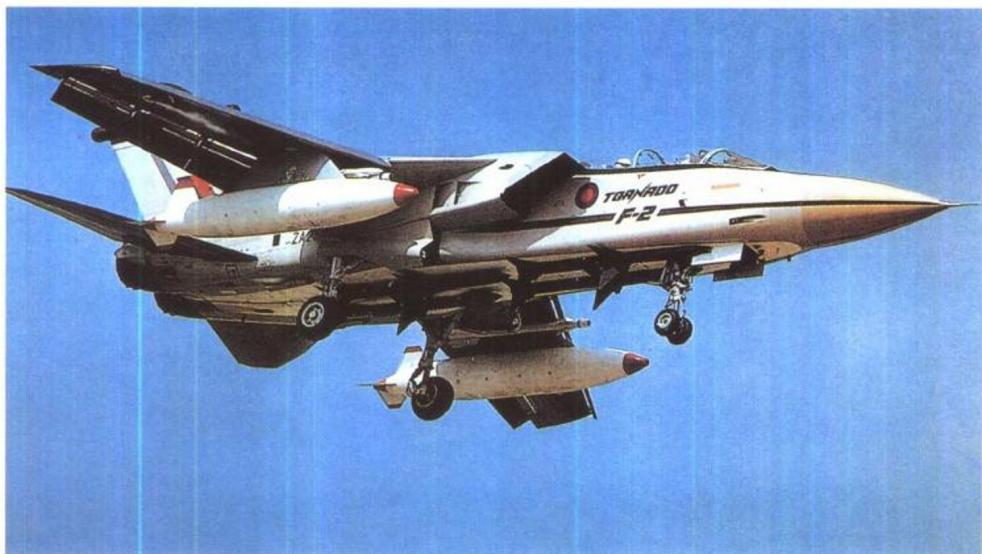
“狂风”是英国、德国、意大利三国合作研制的超音速变后掠翼多用途战斗机。主要有3种型别：对地攻击型装备3国空军和德国海军航空兵；防空型装备英国空军并被阿曼、沙特阿拉伯空军使用；电子战及侦察型装备德国、意大利空军。该机翼展8.6~13.91米，机长18.08米（防空型），机高5.95米，最大起飞重量27950千克，基本空重13890千克，最大载弹量9000千克，最大平飞速度2.2M，实用升限21340米（防空型），起飞滑跑距离760米，着陆滑跑距离370米，转场航程3890千米。其防空型有1门27毫米机炮，4枚半自动雷达制导的“天空闪光”中距空空导弹挂于机腹下，每个内翼挂架均可挂1~2枚AIM-9L“响尾蛇”导弹，4个翼下挂架均可带副油箱，还可挂其它空空导弹。
