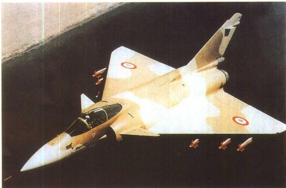
法国“幻影”4000战斗机是法国达索公司研制的单座多用途战斗机，这种飞机基本上是在“幻影”2000的基础上放大而成的，原型机于1979年首飞。其机长18.7米，翼展12米，最大速度2440千米/小时，巡航速度1100千米/小时，实用升限19000米，最大起飞重量25000千克，载弹量8000千克，转场航程3700千米，作战半径1850千米。该机主要武器配置与“幻影”2000相近。目前，该机没有订货，已基本停止生产，但达索公司一直兴致勃勃地表示，要在21世纪初期使这种飞机成为各国争相购买的战斗机。
