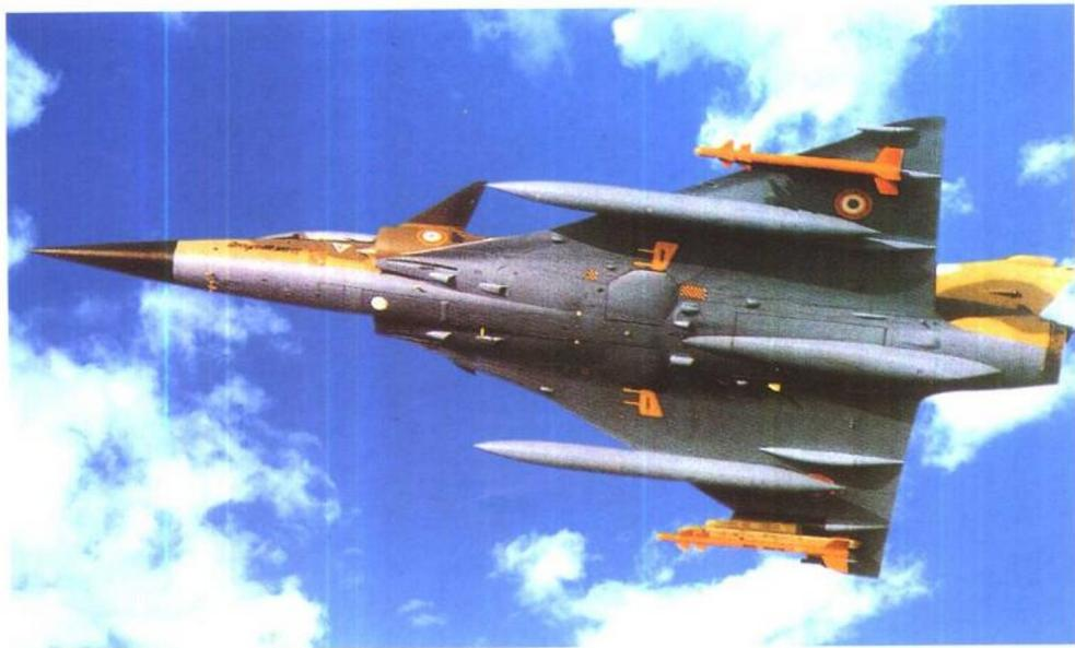
“幻影”50是法国达索公司在“幻影”5的基础上研制的一种多用途战斗机，可执行制空、截击、对地攻击和侦察等任务，主要出口智利空军。其机长15.56米，翼展8.22米，机高4.5米，最大速度2330千米/小时，巡航速度900千米/小时，实用升限18000米，空重7150千克，最大起飞重量13700千克，最大载弹量4000千克，转场航程4000千米。在外挂格斗导弹时可执行制空和截击作战任务，主要用空对地武器执行攻击任务，可改装成侦察型和教练型。该机售价每架约八百五十万美元。
