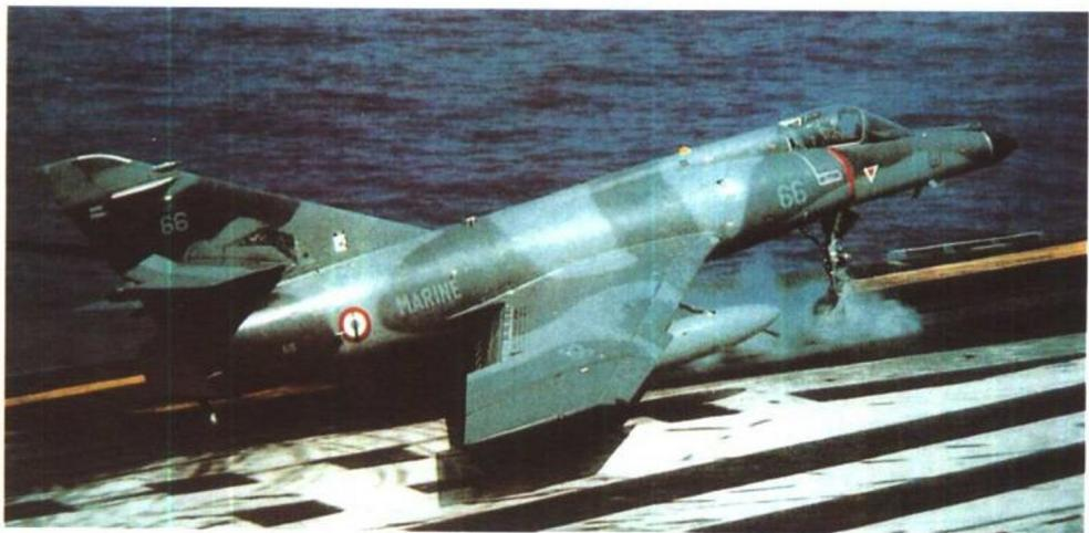
“超军旗”是法国达索公司研制的单座单发轻型舰载攻击机，是80年代后期法国海军航空母舰上服役的惟一固定翼攻击机。该机主要用于对舰队实施空中掩护，保护舰队不受攻击，攻击地面目标，照相、侦察等。其价格约五千万美元。该机翼展9.6米，机长14.31米，机高3.86米，最大起飞重量12000千克，空机重量6450千克，最大武器载重2100千克，最大燃油容量6000升，最大平飞速度约1M，实用升限13700米，起飞滑跑距离100米，着陆滑跑距离500米，作战半径720千米，最大作战半径850千米。机上装有2门30毫米机炮(备弹2×125发)，机身下挂有1个挂架，机翼下有4个挂架，可挂多种炸弹和导弹。马岛海战中，“超军旗”曾携带“飞鱼”空对地导弹击沉了先进的“谢菲尔德”号驱逐舰。
