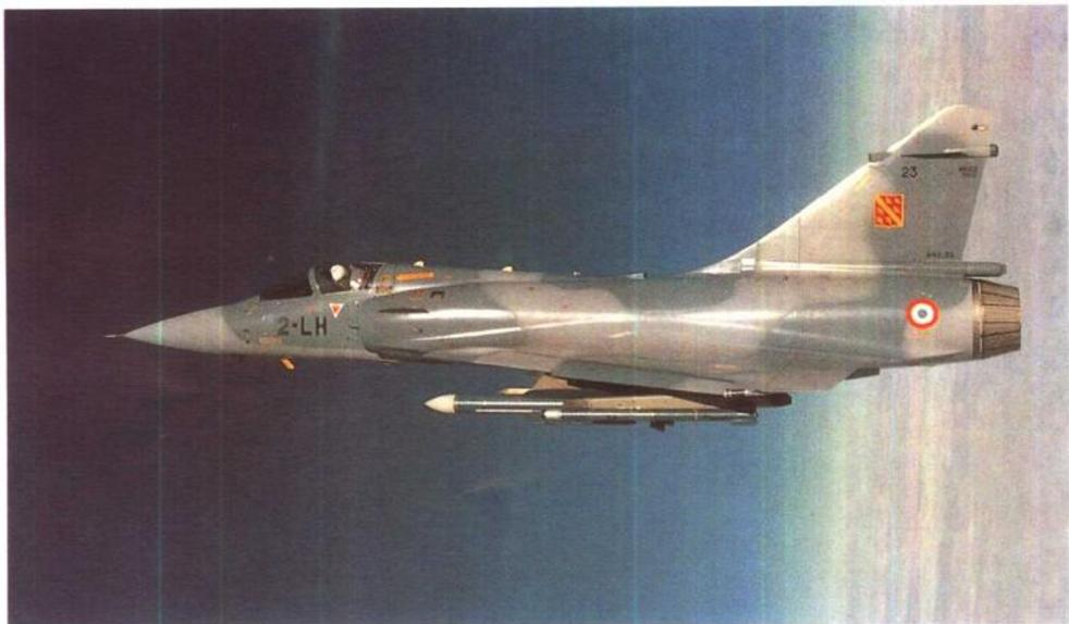
“幻影”2000是法国达索公司研制的单发轻型超音速战斗机，主要用于防空截击和制空，也能执行侦察、近距空中支援和战场纵深低空攻击等任务。该机翼展9.13米，机长14.3米，机高5.2米，最大起飞重量17000千克，正常起飞重量10860千克，空机重量7500千克，最大外挂载荷6300千克，最大平飞速度2.2M，实用升限16460米，起飞滑跑距离460米，着陆滑跑距离640米，转场航程3900千米。装备2门30毫米机炮(备弹2×125发)，有9个外挂点。机身中心挂架和翼内挂架均可载重400千克，机翼外侧挂架均可载重300千克，可挂“马特拉”、“魔术”等导弹及各种炸弹、火箭发射器、机炮吊舱、侦察吊舱、电子对抗吊舱及空中加油吊舱等。
