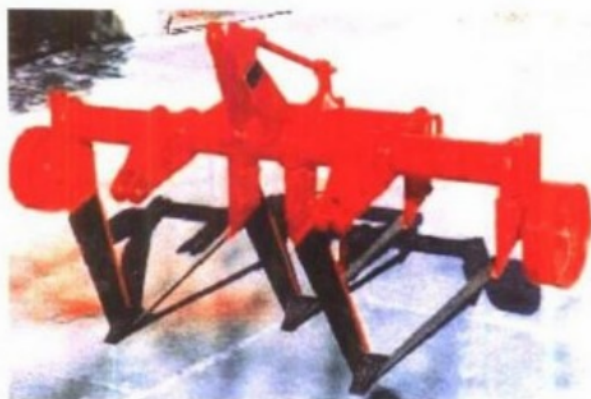
彩图1 与东方红—75型拖拉机配套的全方位深松机
