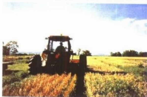
彩图 15 在固定道上 作业的 3m 宽轮距拖 拉机
