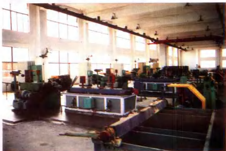
▷自贡中国电焊条厂镀铜焊丝生产线
