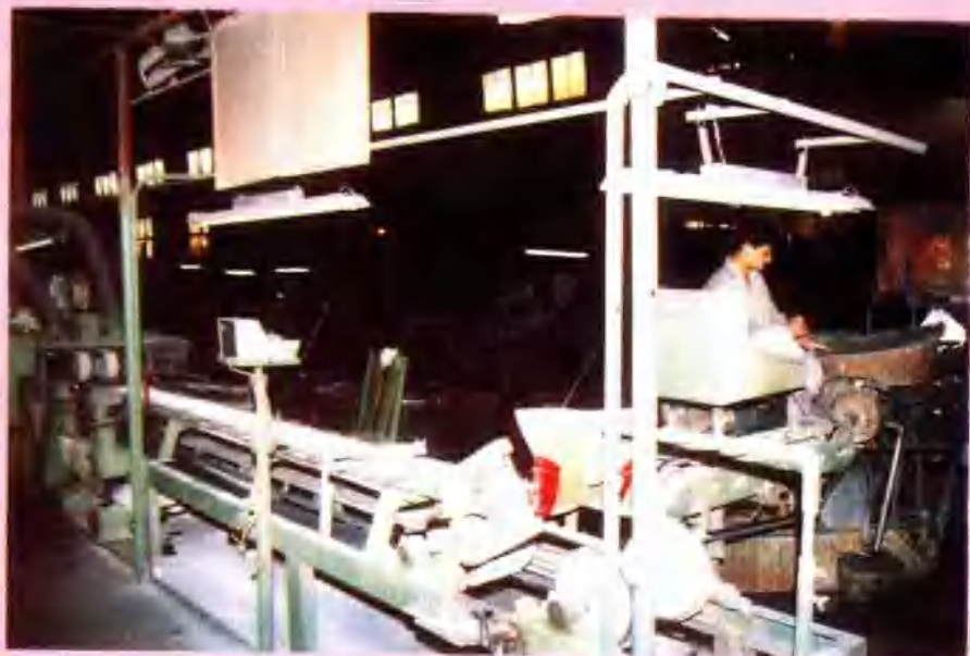
△自贡中国电焊条厂旋转式涂料机
