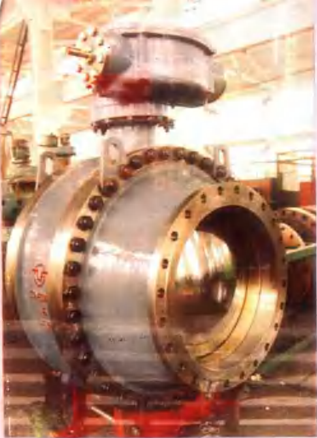
▲(上左)自贡高压阀门厂生产的大口径球阀
