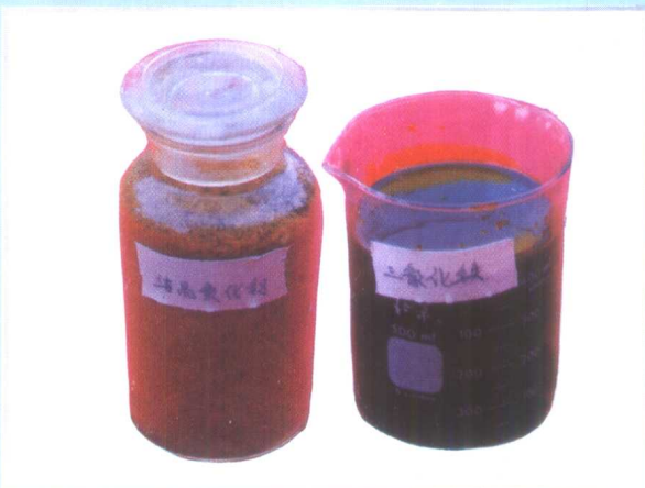
水城矿务局老鹰山矿化工厂利用煤矸石生产的 净水剂 (老鹰山矿化工厂供稿)
