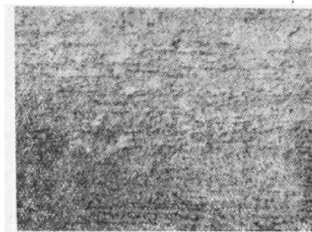
图1 未經热处理的薄膜表面 (PVC:PVA 为 50:50) × 30000
