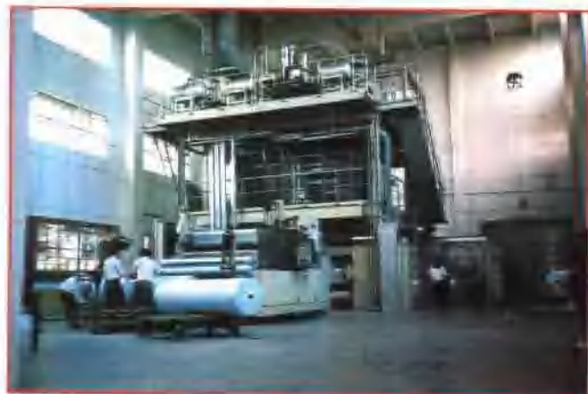
梅县高华化纤实业公司、中外合作梅县新华非织造布有限公司引进德国纺粘法非织造布生产设备。
