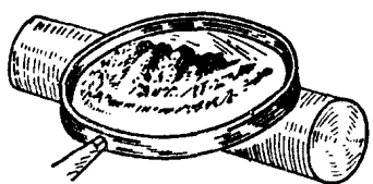
图0-1 加工表面的微观凸起
