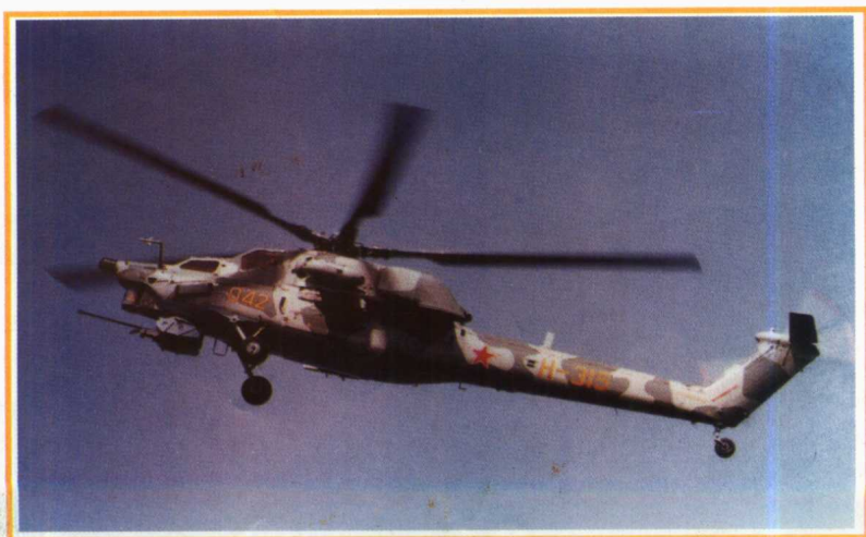
米-28 机头下方有1门30毫米机炮
