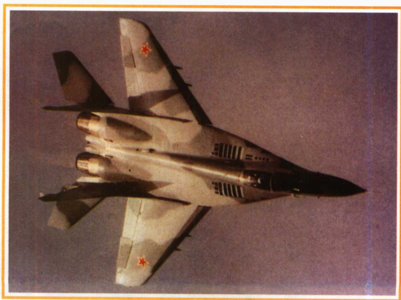
米格-29A 边条翼有百叶窗形的辅助进气口
