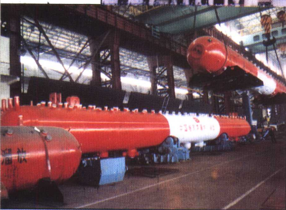
哈尔滨锅炉厂试制的新产品——亚临界锅炉(图为制成的锅炉汽包)
