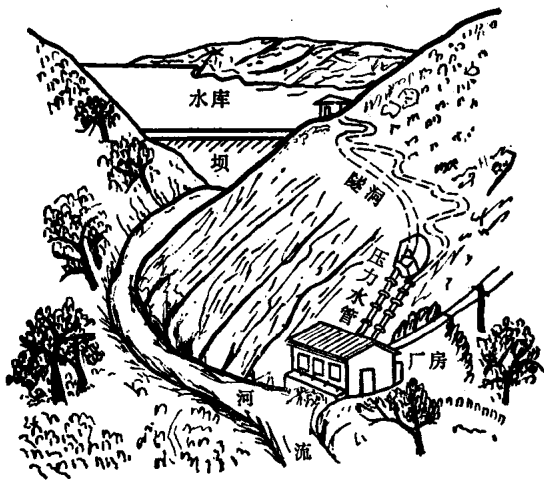
图 1-7 混合式水电站示意图
