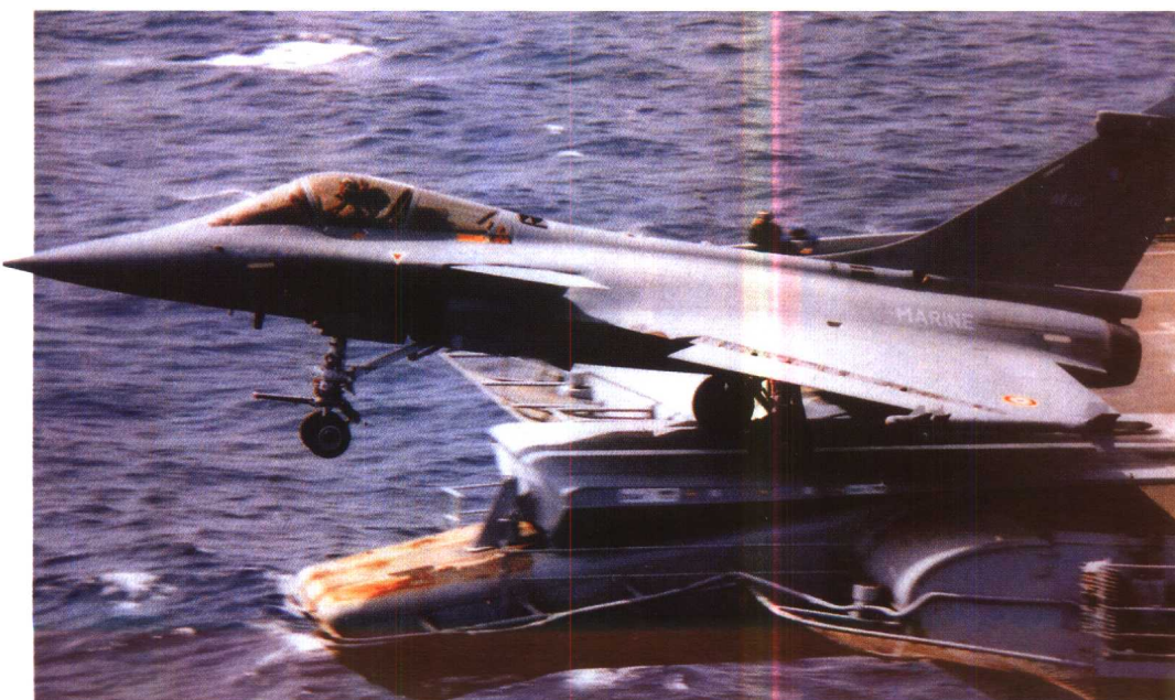
法国新型“阵风”舰载战斗机首次在“福煦”号航母上进行弹射起飞试验
