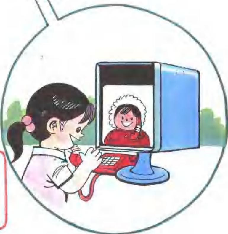
提示：普通电话是将声音变成电流，通过电话线传送到对方，再还原为声音。电视电话是在传递声音变成的电流的同时，将图象变成电流，通过另外的两对电话线传递到对方，再还原为图象。
