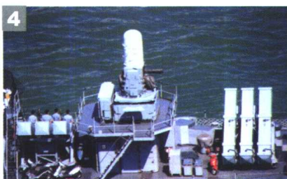
5. 武进三型阳字号驱逐舰除了DDG921辽阳号之外，其余6艘上都安装有一具4联装雄风二型导弹发射器
