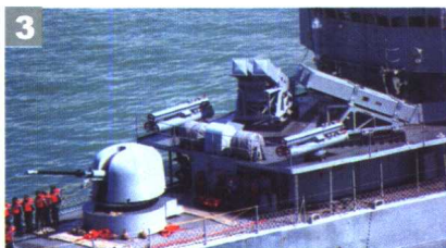
3. 武进三型阳字号驱逐舰舰武备布局 分别为76毫米奥托舰炮、3联装鱼雷发射管和标准型导弹发射箱
