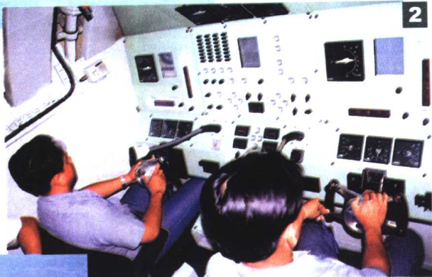
2. 海虎号潜艇控制室内的艇舵艇翼操控台, 海虎号的方向舵和水平舵平时由两人分别操作, 必要时可集中到其中一台由1人操作
