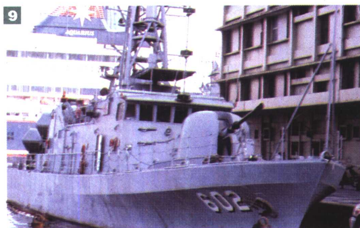
9. 台湾中船公司自制的PSMM Mk5 龙江级导弹快艇绥江舰(PGG602), 该舰与锦江级巡逻艇有些相似, 不过舰船配备一门火力更强的76毫米舰炮
