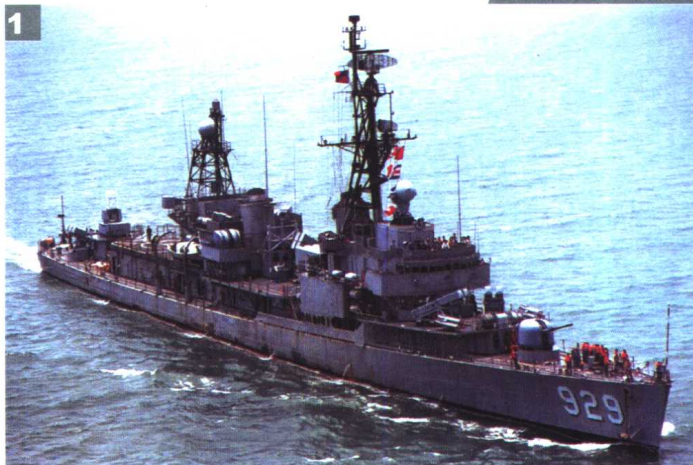
2. 台湾武进三型阳字号驱逐舰只能搭载小型的500MD防御者反潜直升机，图中可见后桅杆上的W-160火控雷达和机库顶端两侧的风扇3号电子战系统天线
