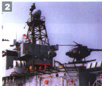
2. 台湾武进三型阳字号驱逐舰只能搭载小型的500MD防御者反潜直升机，图中可见后桅杆上的W-160火控雷达和机库顶端两侧的风扇3号电子战系统天线
