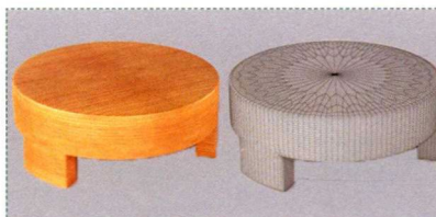
课堂案例：用多边形建模制作木质茶几/90页 视频位置：多媒体教学>CH03 技术掌握：学习“插入”工具、“挤出”工具和“切角”工具的用法
