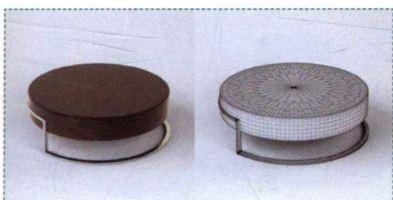
课堂案例：用切角圆柱体制作简约茶几/45页 视频位置：多媒体教学>CH02 技术掌握：学习切角圆柱体的创建方法，并用切角长方体和管状体创建支架
