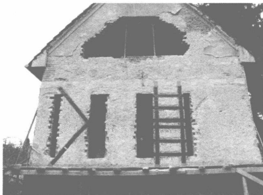
图8 现场墙体剪压复合受力试验 [9]
