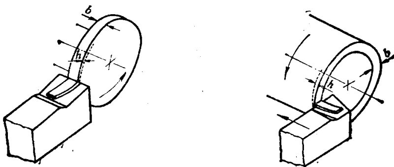
图1-1 直角切削（车削）
