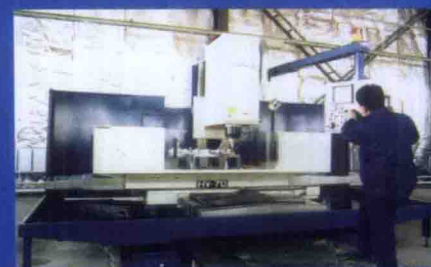
进口立式加工中心进行模具制造
