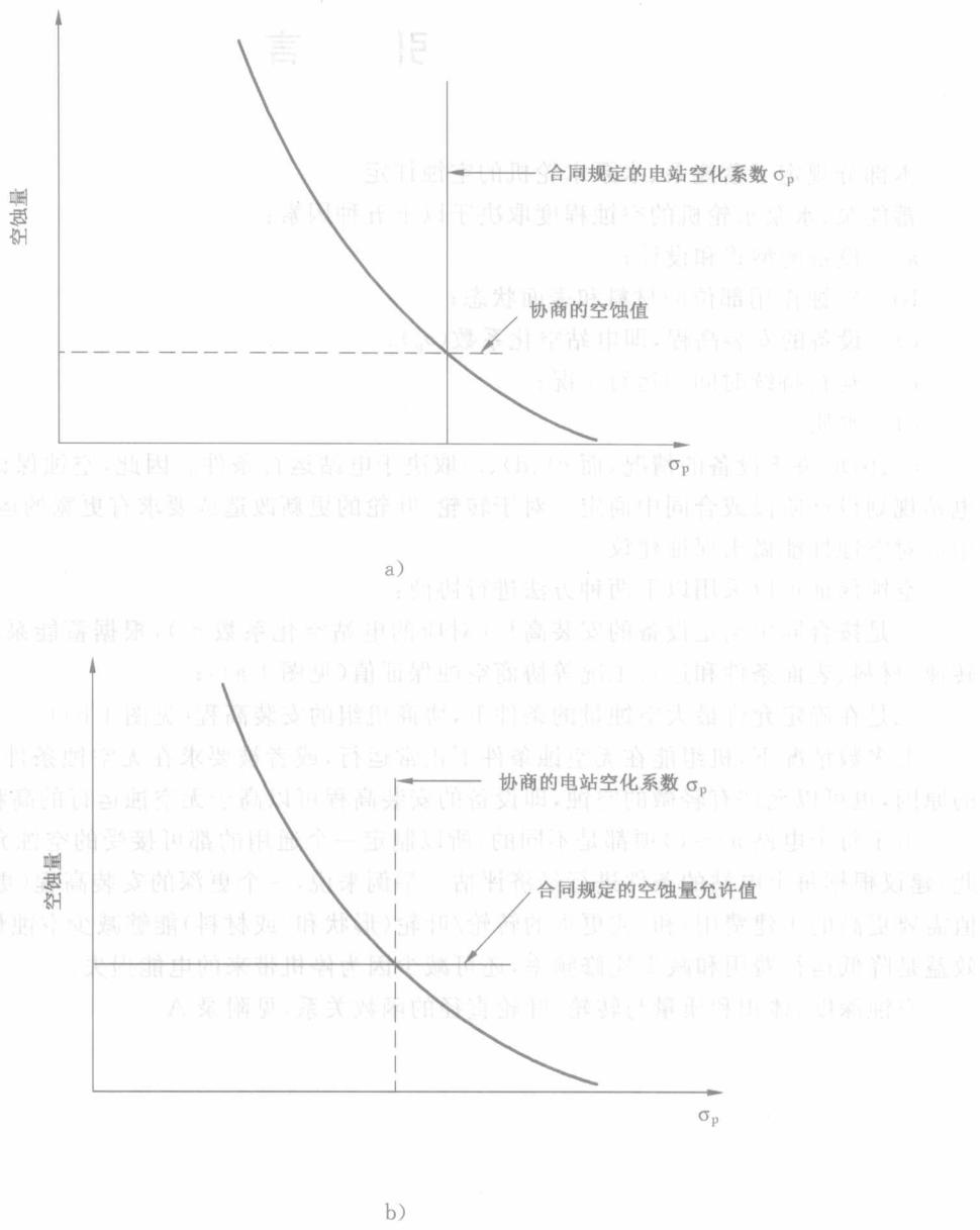
图 1 水力机械在流量一定时的空蚀量与电站空化系数的函数关系
