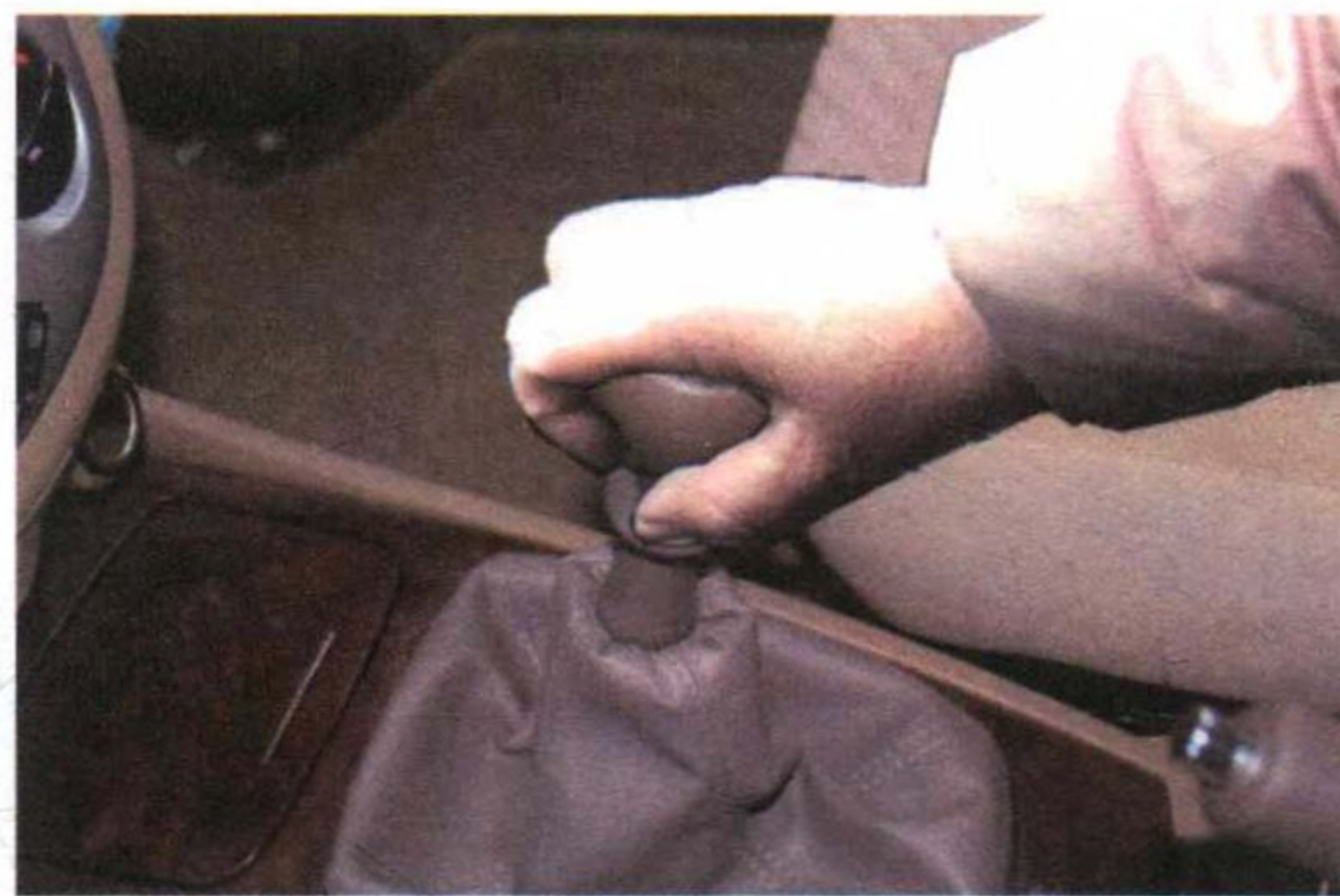
图2-8 检查变速杆是否在空挡
