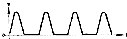
图 1-5-2 在图 1-5-1 半波整流电路中， R_L 上的直流电压波形
