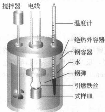
图 1-1 弹式量热计示意图
