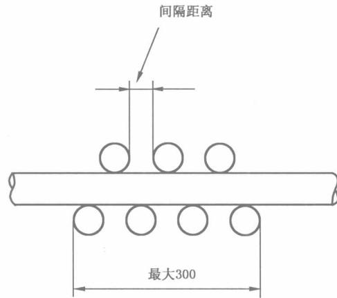
图 1 安装在标准钢梯两侧的电缆典型排列和间隔(A F/R 类)
