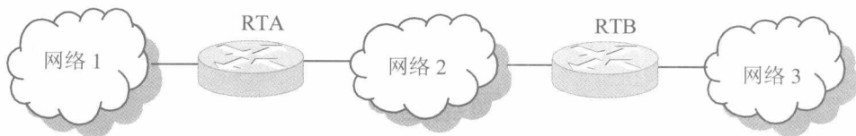
图 1-3 使用两个路由器互联的三个网络
