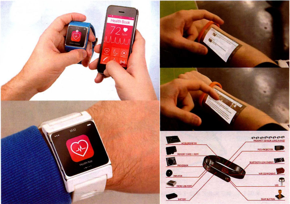
彩图 2-9 可穿戴智能腕表提供生理数据监测（左）和将皮肤延伸成屏幕的投影手环（右）
