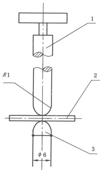
1——上电极(其高度根据上电极质量 50 g 的规定调整);
