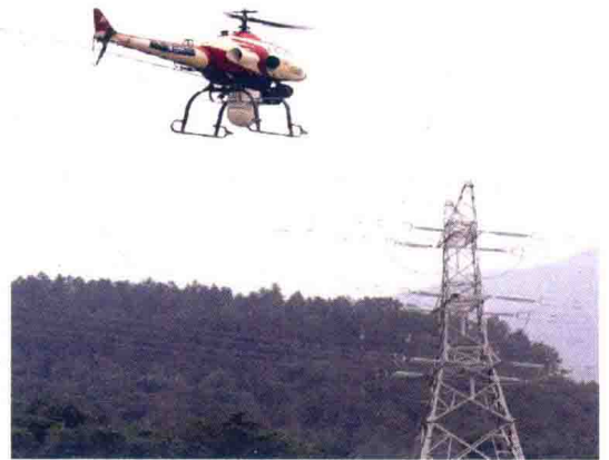
图 1-2 福建电网 Z-3 无人机电力线路 精确巡检
