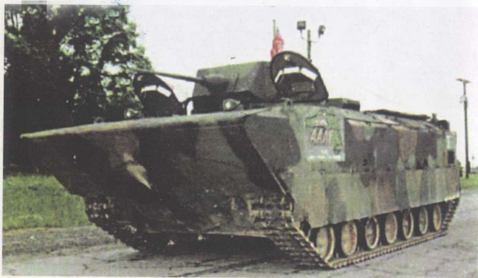
AAV 先进两栖突击车是水上速度最快的 两栖突击车，最大速度达 46 千米/小时
