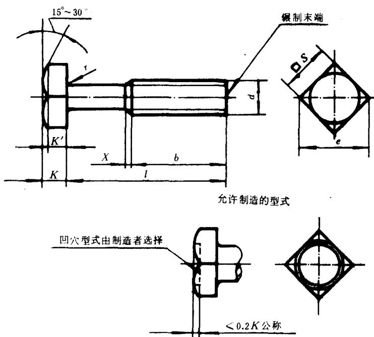
末端按 GB 2 规定；无螺纹部分杆径约等于螺纹中径或螺纹大径。
