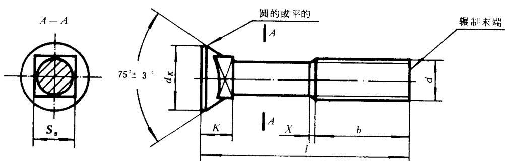
末端按 GB 2 规定；无螺纹部分杆径约等于螺纹中径或螺纹大径。
