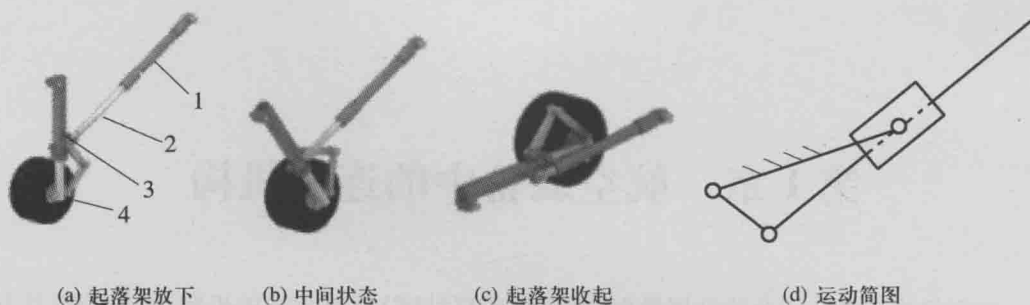
图 1-2 直-9 主起落架装置
