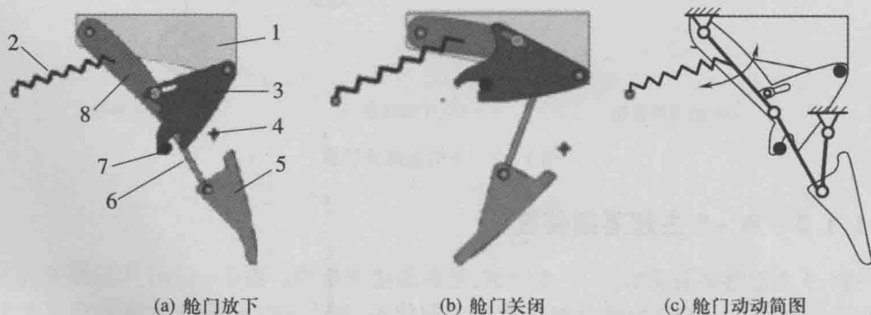
图 1-3 直-9 主起落架舱门操纵机构示意图
