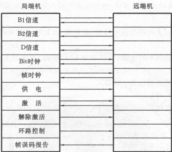
图 3 局端机和远端机之间的传输功能
