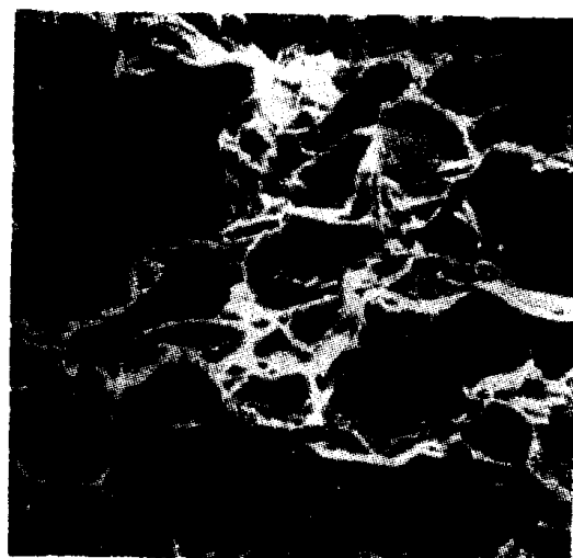
e. A14-87 炉号亮条处断口 \times 1000
