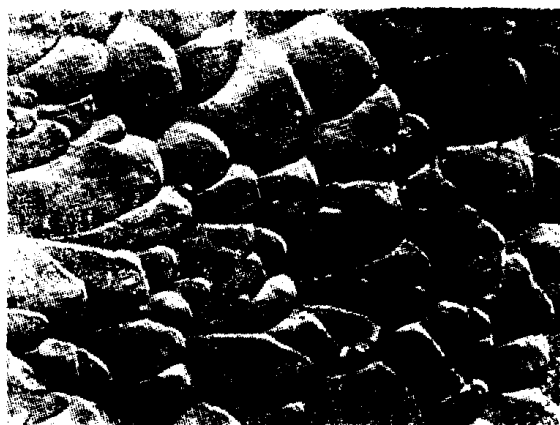
a. 正常组织塑性断口 \times 3000
