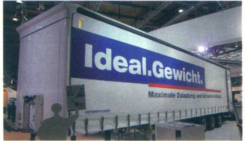
图 1-10 前墙使用铝合金材料的侧帘厢式半挂车
