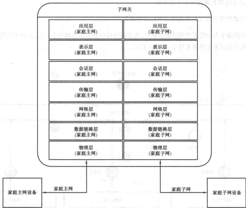
图 8 内部子网关的层次结构参考模型
