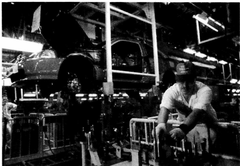
在美国俄亥俄州的东部自由汽车生产厂，一台发动机和一组驾驶套件正被吊进一辆新型西域车身里。旁边是一位生产线同人正在准备下一个模型。
