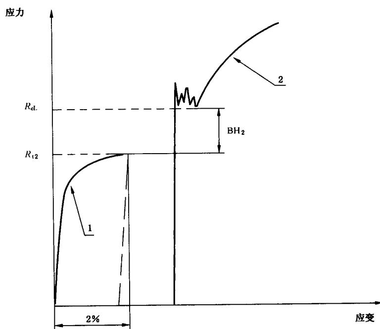
1——2%预应变的应力-应变曲线；
