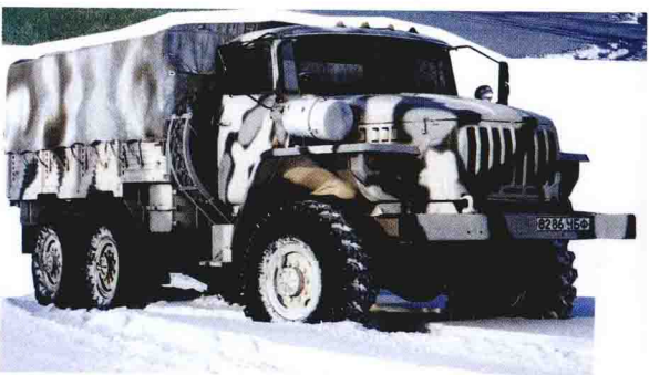
公路载质量63.5吨，最大时速72千米/小时，整车可由C-5A运输机空运。
