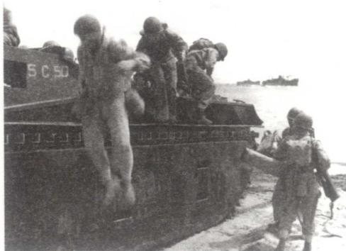
图中LVT-1型“短吻鳄”履带式两栖登陆车没有被用来攻击敌军，而是被用来将刚卸下船的军需牵引到岛内和前沿阵地。这种两栖登陆车装备了3挺机枪，无装甲防护（因而车体相对较轻），腹部离地高度较低，因而易于“浮行”通过树墩和淤泥地带。陆战队还用LVT-1型“履带式两栖登陆车来投送预备部队。这种两栖登陆车的故障率很高，一旦出现故障，就被推入河中当作铺设车桥的支撑物。（美国海军陆战队历史中心）
