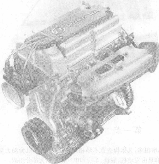
图 1-3 五菱荣光 B 系列发动机的外形
