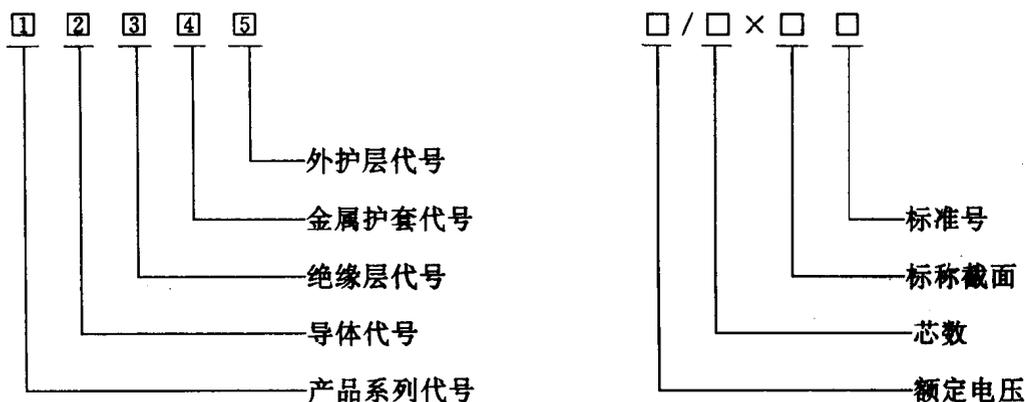
鉴于各种型号的充油电缆均有相同结构的内衬层和保护加强层的保护层,故内衬层和保护层特征不在电缆型号中表示。电缆外护层代号,按电缆外护层结构从里到外用加强层、铠装层、外被层的代号组合表示。
