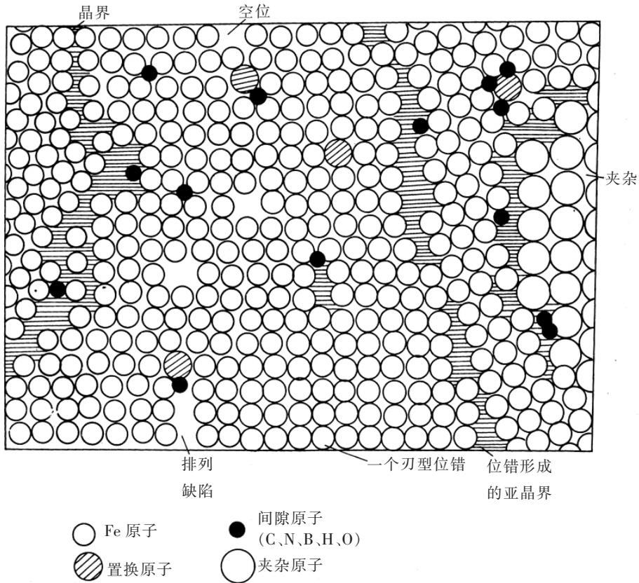
图 1-2 实际金属的结构示意图
