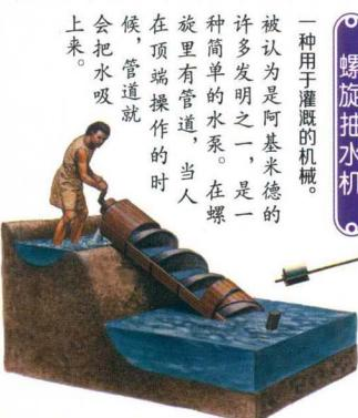
被认为是由阿基米德的许多发明之一，是一种简单的水泵。在螺旋里有管道，当人在顶端操作的时候，管道就会把水吸上来。
